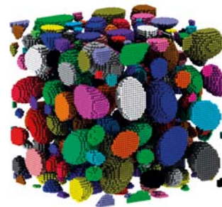
Simulation eines mikroskopischen Ausschnitts des Gießschlickers (nur Feststoffpartikel dargestellt).
